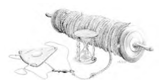
Loggrull, måleglass og loggflyndre (tegning av forfatteren).
